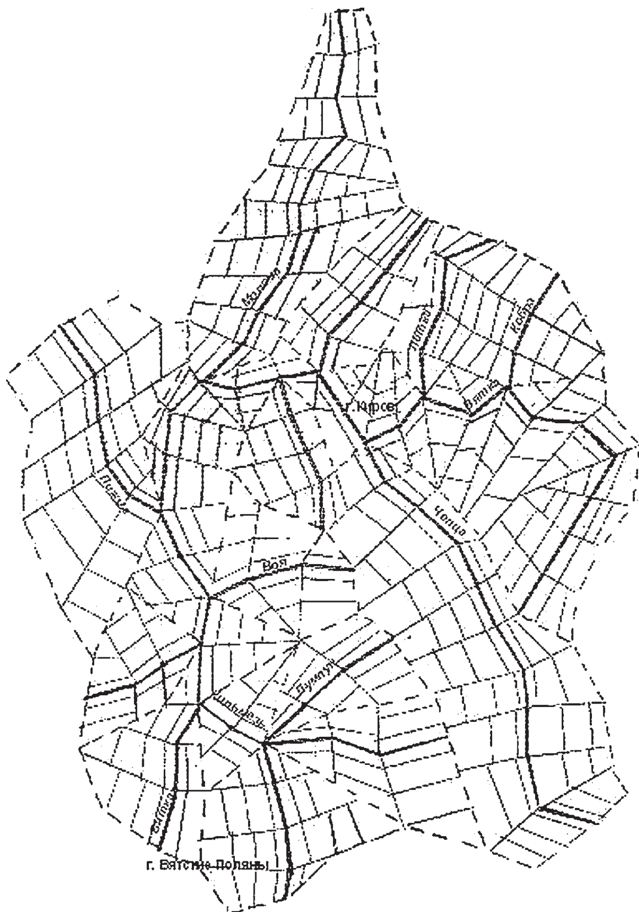
Рис. 1. Конечно-элементная схематизация водосбора р. Вятка
